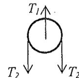
$$T_1 - 2.T_2 = 0 \rightarrow T_1 = 2.T_2$$
