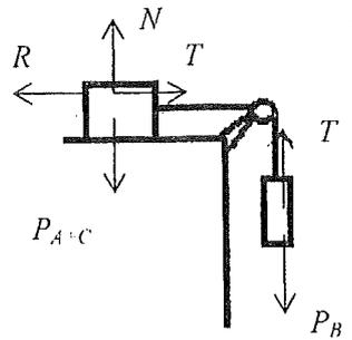
Para el conjunto "A+C", despejamos de la ecuación del eje "y":  $N = P_T = M_T \cdot g$
