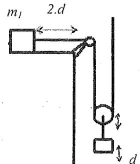
Y derivando esta relación dos veces se deduce que la aceleración del 1 hacia la derecha vale el doble que la del 2 sobre el eje  $y$ .
