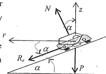
Marqué el ángulo " $\alpha$ " en cada caso: para la Normal, vimos en el dibujo que es el ángulo comprendido con el eje "z" vertical, para el rozamiento, por alternos internos, se ve que es el ángulo que forma con la dirección radial. Escribimos la 2<sup>da</sup> ley:
