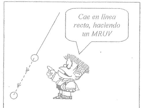
**Observación:** muchos alumnos contestan que el péndulo tendría que hacer un tiro horizontal. Nada más equivocado. En ese caso la velocidad inicial debería ser horizontal (aquí no hay), y la aceleración ser perpendicular (o sea, hacia abajo, aquí en cambio también hay aceleración en el eje x hacia atrás)
