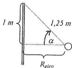
Como se muestra, el ángulo que forma cada soga con el eje radial se puede obtener gracias a la información del largo de la cuerda (hipotenusa del triángulo punteado) y la distancia sobre el eje (cateto opuesto del mismo triángulo). Por trigonometría:
